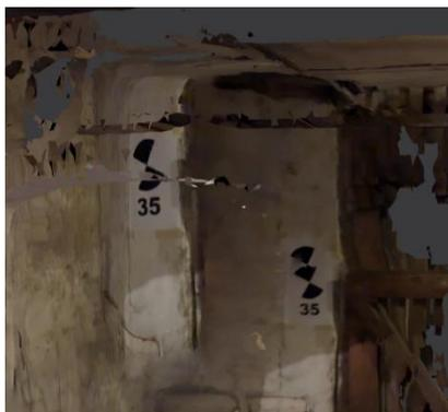
Abbildung 29: Zielmarken erfasst mit 3DScannerApp, verschoben und an falscher Stelle dargestellt
