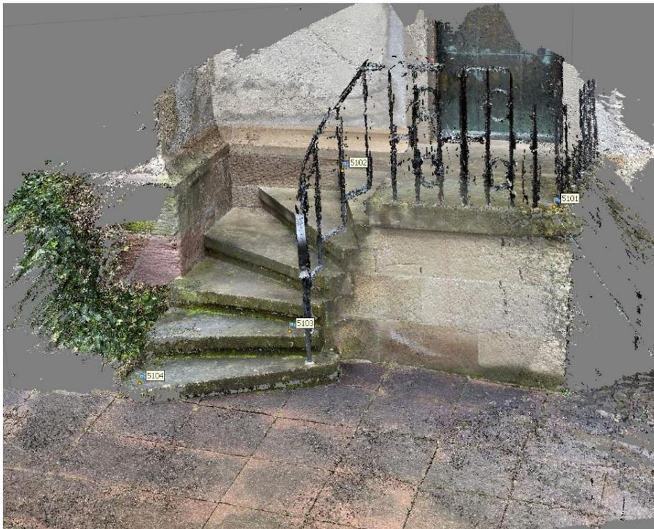
Abbildung 34: Berechnete Dense Cloud mit Passpunkten
