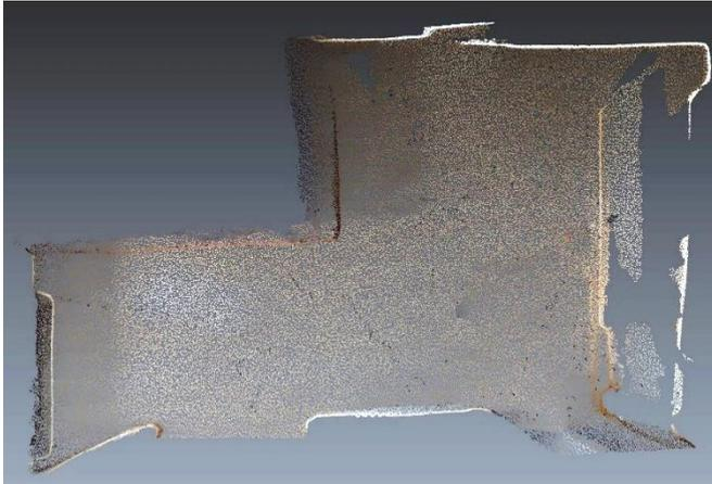
Abbildung 60: Messobjekt Innenraum 2 - Applikation 3DScannerApp, Grundriss
