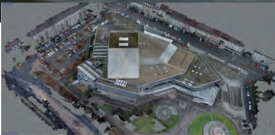
Punktwolke aus UAV Befliegung
